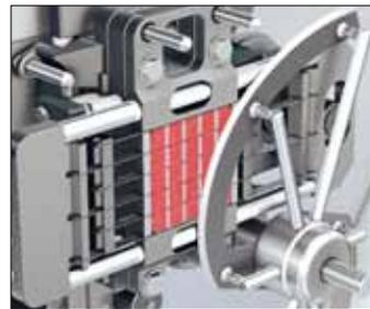
Exzellente Schneidergebnisse dank patentiertem Filetiergatter (optional). Damit wird höchste Schnittgeometrie erzielt, welche zu exzellenten Schneidergebnissen führt, insbesondere bei empfindlichen Produkten wie gegerstem Fleisch oder Brühwurst.
