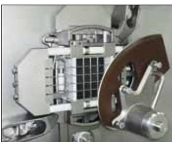
Der minimale Abstand zwischen Abschneide- und Gattermesser, das so genannte „Scherenschnitt-Prinzip“, ist eine der grundlegenden Voraussetzungen für exzellente Schneidergebnisse.
