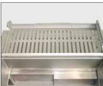
Die seitliche Querpressung für die optimale Komprimierung des Produktes besteht aus zwei unabhängig voneinander arbeitenden Stempeln. Die Seitenpressung kann per Knopfdruck ein- und ausgeschaltet werden.
