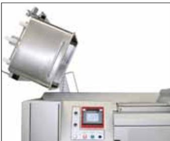
Der TWISTER SP bietet zahlreiche Beschickungsmöglichkeiten. Eine davon ist die Hebe-Kipp-Vorrichtung für 200-l-Normwagen. Die Produkte fallen dann auf die Maschinenwanne, von wo aus der Bediener die Maschine manuell beschickt.
