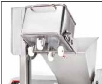
Trichter und Schneidkammer verfügen über ein enormes Fassungsvermögen. Mit einer Einlegelänge von 620 mm und einer Einlegebreite von 240 mm bietet die Schneidkammer viel Platz, auch für große Schulterstücke.
