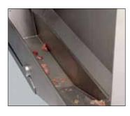
Das PQS (Produkt-Qualitäts-Separation) verhindert, dass eventuell auftretende Produkt-Reste in das Gut-Material gelangen. Das Gatter wird durch das PQS abgeschirmt (siehe auch Foto oben), so dass Rest-Material hinter die Wand fällt, wo es aufgefangen wird.
