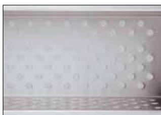
Noppenblech: Zwischen den Noppen entsteht ein Luftpolster, auf welchem das Produkt zum Messer geführt wird.
