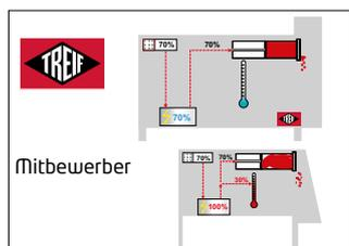
Durch das DHS (Dynamisches Hydraulik System) wird die Haltbarkeit der Schneidgüter verlängert (geringere Wärmeentwicklung der Maschine, weniger Bakterienbildung).
