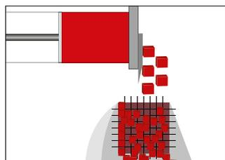
Das AVS (Automatisches Vorpress-System) ermöglicht eine optimale Formgenauigkeit der Wüfel bzw. Streifen von Beginn an.
