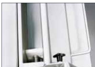
Mit dem kippbaren Trennschneider wird überstehendes Material in die Kammer gedrückt, deren Kapazität so stets voll ausgeschöpft wird.
