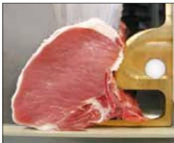
Produktbewegung wirkt sich negativ auf den Schnitt aus. Deshalb gibt der Rippenstabilisator knochenhaltiger Ware zusätzlichen Halt und minimiert dadurch den Schneiddruck auf das Produkt.
