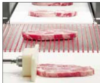
Optional sind Waage und Sortierstation erhältlich. Der Toleranzbereich für Abweichungen vom Sollgewicht wird vom Bediener festgelegt. Fehlgewichtige Scheiben werden automatisch aussortiert.
