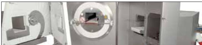
Mit nur wenigen Handgriffen ist der FALCON in Reinigungsstellung gebracht. Für die sensiblen Bauteile (z.B. Scanner) werden Schutzabdeckungen mitgeliefert.
