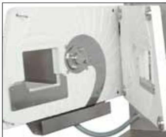
Das patentierte Sichelmesser wird stabil gehalten. Durch diese so genannte Sandwich-Führung (Edelstahl-Platten optional) werden Keilschnitte ausgeschlossen. Das Ergebnis sind saubere Schnitte und eine erhöhte Ausbeute.
