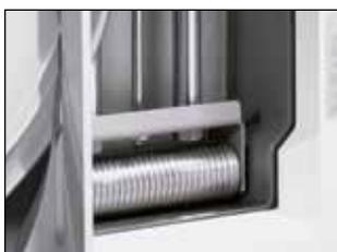
Der pneumatische Niederhalter stabilisiert die gefrorene Ware, damit keine keiligen Scheiben entstehen und für eine hohe Ausbeute gesorgt wird.
