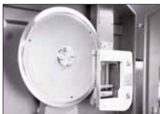
Während das Planetengetriebe eine Umdrehung vollzieht, dreht sich das speziell verzahnte Kreismesser mehrfach um die eigene Achse. Durch die lange Schneidlänge des Kreismessers entsteht ein sauberer Schnitt.
