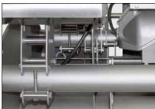
Komplette Waage nach Schutzklasse IP 66: geschützt gegen starkes Strahlwasser (eine kundenorientierte Lösung nach den HACCP-Richtlinien).
