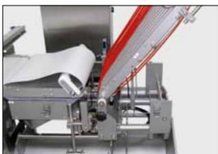
Einfaches Lösen der Transportbänder ermöglicht gründliches und schnelles Reinigen. Der Check-Weigher entspricht den HACCP-Richtlinien.
