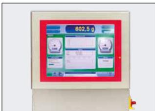
Die Bedienung erfolgt über ein Touch-Screen-Display (15-Zoll) mit komfortablen Navigationshilfen und „Benutzerprofilen“. Der Neigungswinkel des Terminals ist verstellbar.
