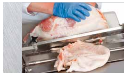
Entschwarten und Entfetten in einem Arbeitsgang.
