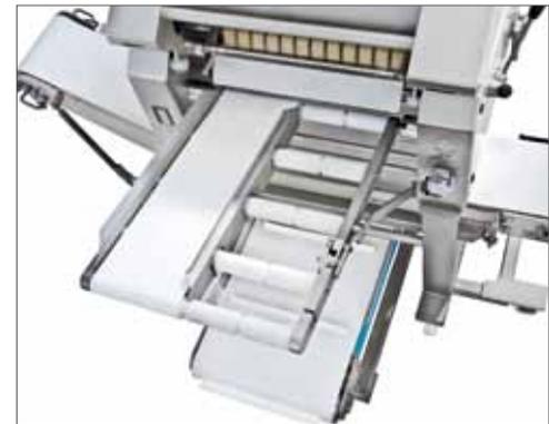
Bandsysteme zur Teilezufuhr, Rückführung zum Bediener und Abtransport der beidseitig entvliesten Teilstücke.
